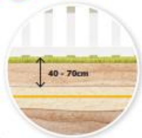
4A VERLEGUNG DES LEERROHRES
