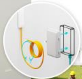
4C MONTAGE DES HAUSANSCHLUSSKASTENS
